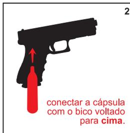
conectar a cápsula com o bico voltado para cima.
