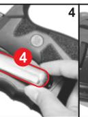
**Atenção:** Mantenha sempre o bico da cápsula de CO2 apontada para cima no momento da conexão.
