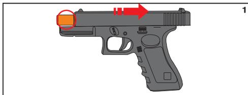
Use óleo de silicone puro (nunca use qualquer outro tipo de óleo) que deve ser aplicado nos locais circulos em vermelho. Coloque duas ou três gotas na parte externa do cano para facilitar o deslocamento do slide sobre o cano.
