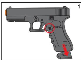
1 Para remover o carregador aperte o retém. Conforme indicado na imagem.
