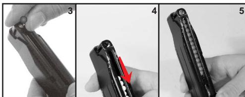
Puxe até o fundo do carregador, a alavanca guia das esferas (BB's) e deixe o carregador um pouco inclinado para frente para alimentá-lo com as esferas. A capacidade máxima do carregador é de **21 esferas**. Então, recoloque o magazine no compartimento até que ouça um clique.
